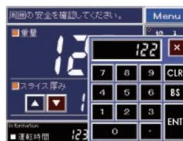
操作はタッチパネルを採用。設定項目は重量のみ。型の交換無しで目標重量の設定は任意に可能。
