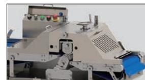
特殊星型刃が筋をカットし、硬いお肉もやわらかくします。上下の刃の間隔はハンドルひとつで調整可能。生産アイテムに応じて使い分けられます。
